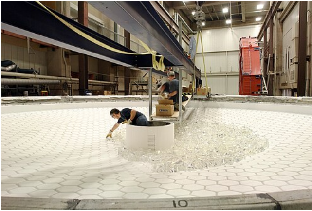
Les blocs de verre sont placés sur la forme du miroir M1 avant les opérations de fusion.
