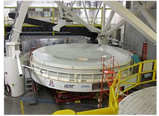
Les miroirs M1 et M3 sont façonnés dans le même bloc de verre monolithique. On distingue le M3 par sa courbure plus accentuée.
