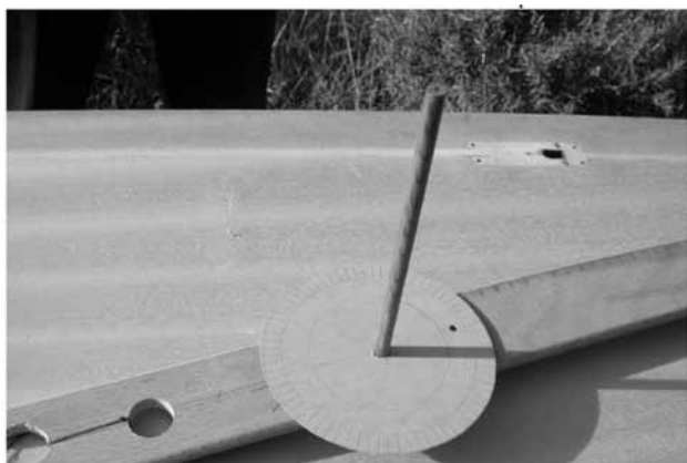
Figure 11. L'ombre du gnomon est sur la 4ème marque après celle qui correspond à l'alignement nord-sud. Donc un angle de 20^\circ environ, soit 200^\circ /nord. La photo a été prise le 5 décembre à 12 heures 43 TU et l'azimut était de 200^\circ 12' 07'' /nord. La précision n'est pas celle d'une horloge atomique, mais elle est quand même admirable. Photo Jacques Wolkiewiez.
