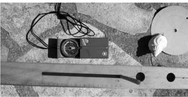
Figure 10 En haut, photo prise à midi au moment de l'équinoxe de printemps avec le gnomon de 18 cm utilisé en été et en hiver. La longueur de l'ombre est intermédiaire à celles de l'été et l'hiver.
