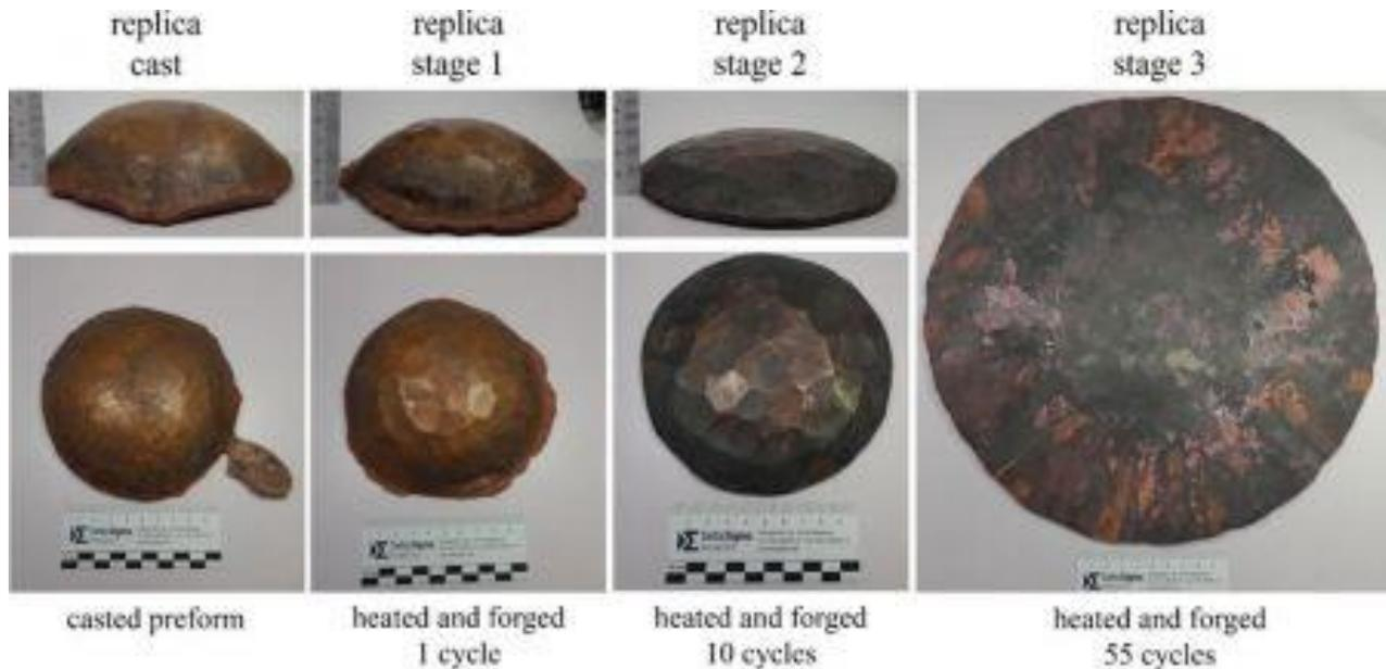
*Photos des différentes répliques correspondant à divers stades du forgeage : a) ébauche coulée ; b) étape 1 après un cycle de chauffe et de forgeage ; c) étape 2 après 10 cycles de chauffe et de forgeage ; d) étape 3 après 55 cycles de chauffe et de forgeage et avant finalisation du disque par un dernier recuit. Crédits*
